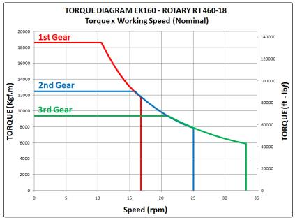
108650070\_0000202 Torque Diagram-Rotary RT460-18
